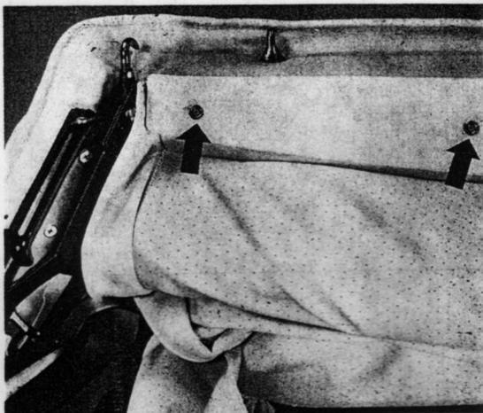
17 - Avvitare la lamiera di copertura testata capote mediante cinque viti con intaglio a croce. Attenzione a non dimenticare le rondelle.
