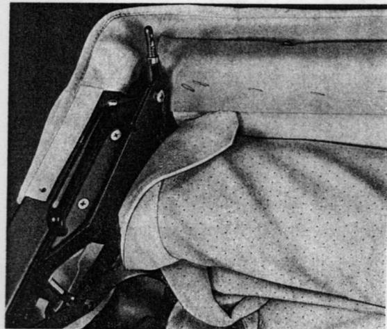
21 - Spalmare di collante plastico D 11 i lembi di fissaggio del rivestimento capote nella centina principale.
